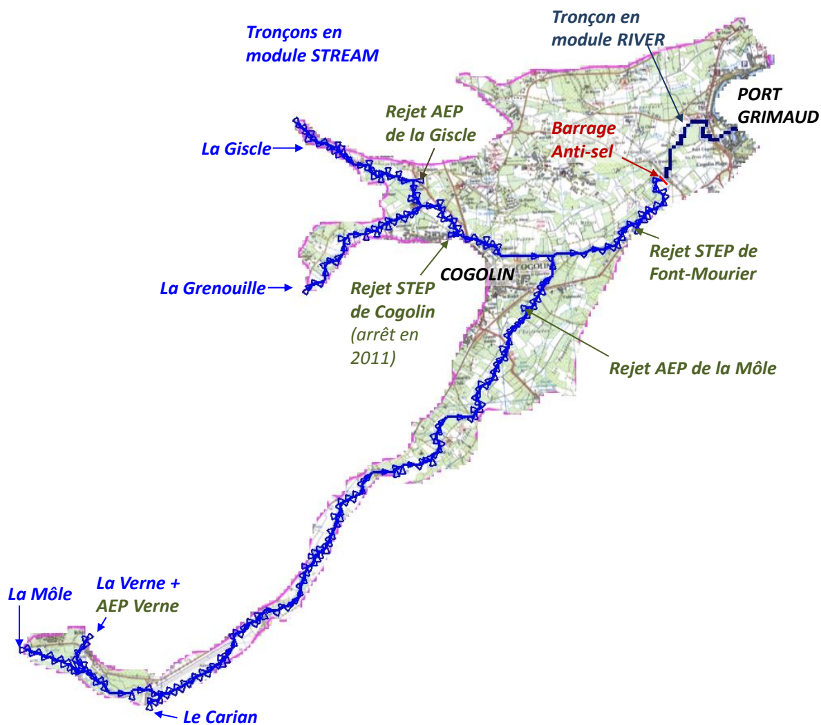
Figure 18 - Cours d'eau et points de restitution intégrés avec les modules Stream et River
