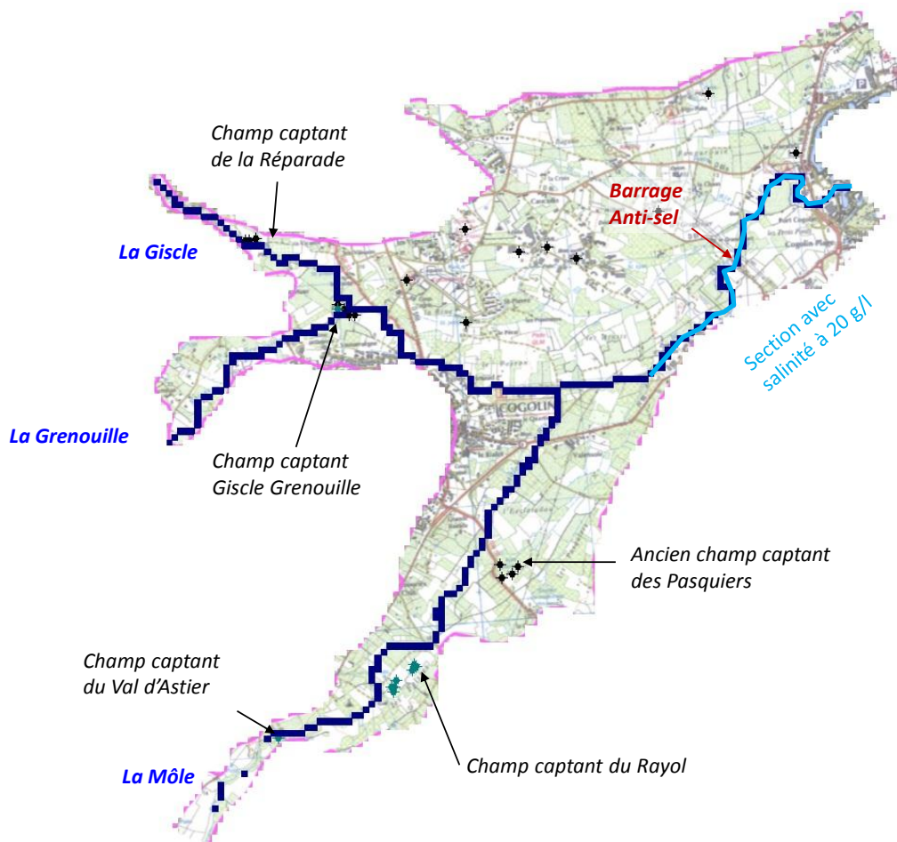
Figure 61 – Carte des champs captant en fonctionnement en 1980 et section de la Giscle le contenant de l'eau saumâtre avant la mise en place du barrage anti-sel
