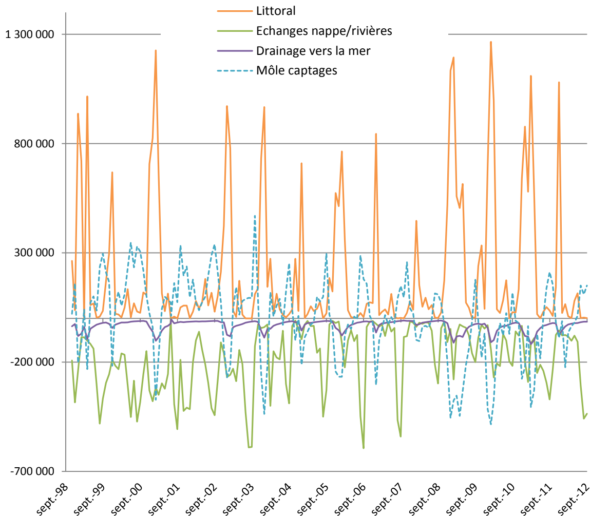
Figure 41 - Evolution annuelle des termes du bilan hydraulique souterrain en m 3 /mois
